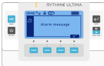
Signaux visuels typiques d'une alarme de faible priorité
